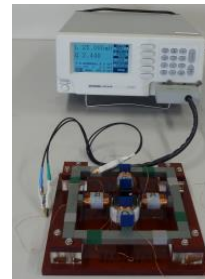
作製コイルを組み込んだ状態で、各コイルのLCRメータ計測 (4個のコイルを計測)
