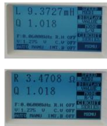
各作製コイルのLCRメータ計測 (4個のコイルを計測)
