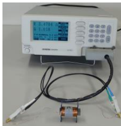
各作製コイルのLCRメータ計測 (4個のコイルを計測)
