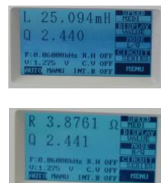
作製コイルを組み込んだ状態で、各コイルのLCRメータ計測 (4個のコイルを計測)
