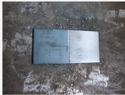
開先加工後、 溶接前
