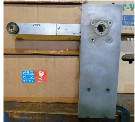
図 1 締付トルク体感装置
