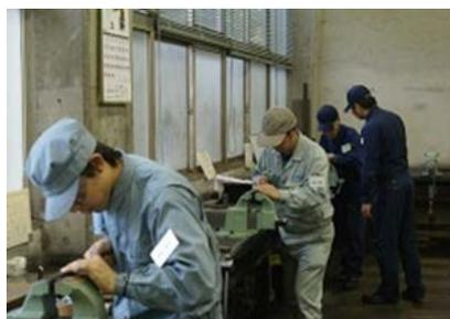
Fig.1 仕上げ（ヤスリがけ）指導
