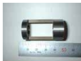
図 14. 中央部板厚 0.4mm
