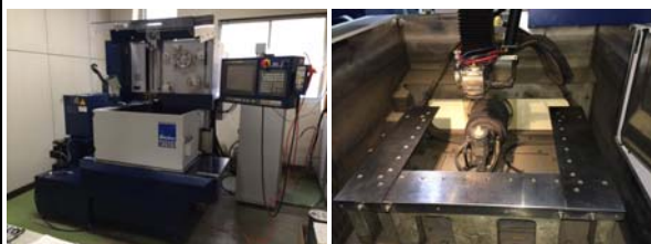
図1. ワイヤ放電加工機（外観および加工槽）
