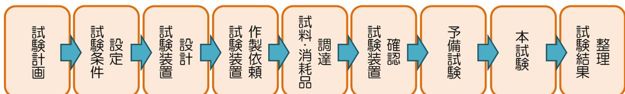
図-2 新規作製試験装置の場合のサポート
