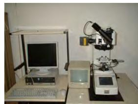
図14. マイクロビッカース硬さ試験機
