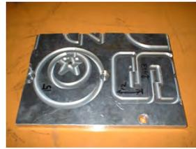
図7. 溝幅測定対象物
