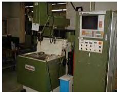
図 28 型彫り放電加工機
