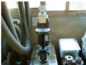
図13. ロックウェル硬さ試験機
