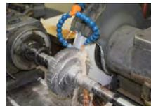
平面研削盤は、材料を電磁テーブルに固定、往復運動させ平面のきれいな面粗さや平行に仕上ることができる。内面研削盤は、砥石に回転、材料も回転させ、穴を仕上る。円筒研削盤は砥石に回転、材料も回転させ、棒状の材料を仕上る。図 17 は、マンドレルに歯車を差込み歯車外周と側面の研削仕上げである。
