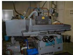
図11. 平面研削盤
