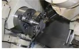
図 25 旋盤加工
